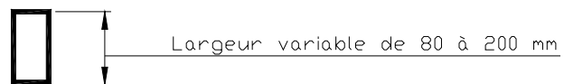
Figure 1 – Murs – Type de profils utilisés – Épaisseurs minimales pour profilés porteurs : 15/10° de mm
