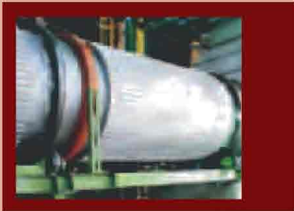
„Zařízení k odmašťování okují a okujových kalů“ (závod 14 – Válcovny)
